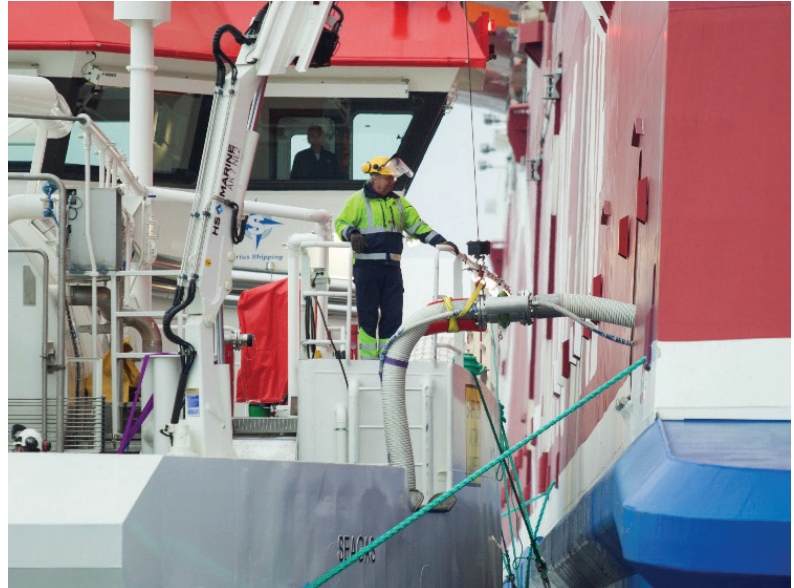
Viking Grace takes on LNG from Seagas, the world's first LNG bunker vessel.
